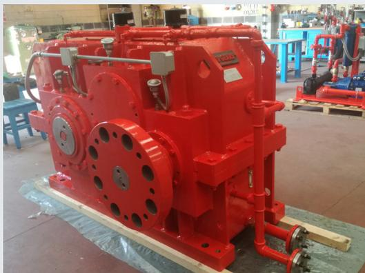
*Reductor repotenciado, con sistema de lubricación por inyección y con elementos de monitoreo incluidos, así como los acoples flexibles incluidos y sistema de lubricación.*
